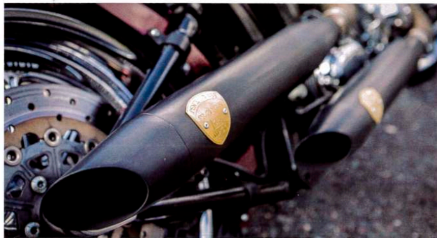
Die Lampe wurde seitlich versetzt montiert, um Platz für die gewünschte Verkleidung zu schaffen. Der Auspuff wird per Knopfdruck geregelt und gibt seine brutale Lautstärke nur dann frei, wenn man will
