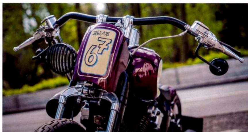
Die Lampe wurde seitlich versetzt montiert, um Platz für die gewünschte Verkleidung zu schaffen. Der Auspuff wird per Knopfdruck geregelt und gibt seine brutale Lautstärke nur dann frei, wenn man will
